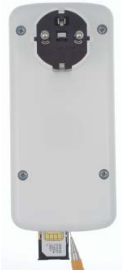
Obrázek 7 – Vyjmutí/vložení SIM karty u GSMRELE2
