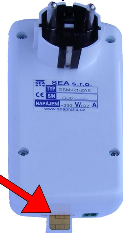
**Zjištění stavu zařízení** – Pošlete SMS zprávu tvaru **1234 STAV** na tel. číslo SIM karty vložené do GSM R1 ZAS. Zařízení Vám pošle zpět SMS zprávu s aktuálním stavem např. **GSM R1 ZAS: zap PROVEDENO, Rele=zap, Signal= 54%, Tepl=28°C**.
